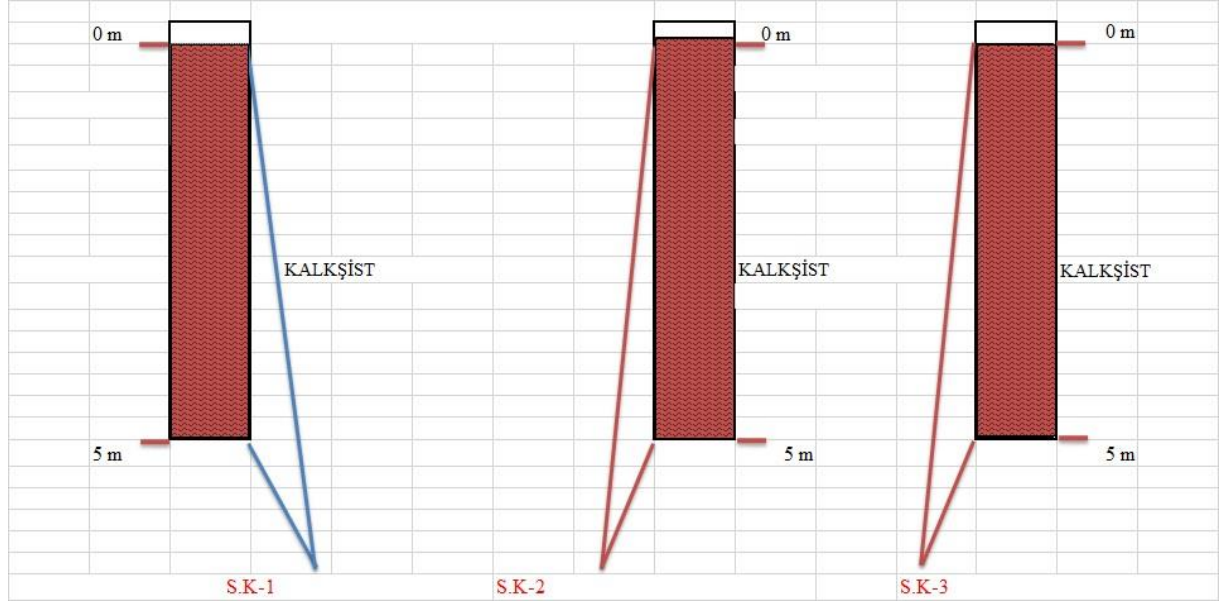
Şekil 1: Sondajlara bağlı zemin profilleri.
